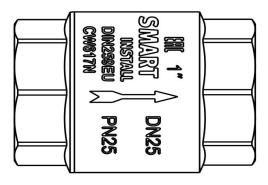
Монтаж обратного клапана следует производить при помощи рожкового ключа за шестигранник корпуса.
